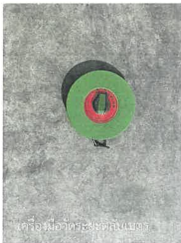
รูปที่ 4.1.5-3 ตัวอย่างเครื่องมือวัดระยะห่างของบ้าน/อาคารข้างเคียงโครงการ
